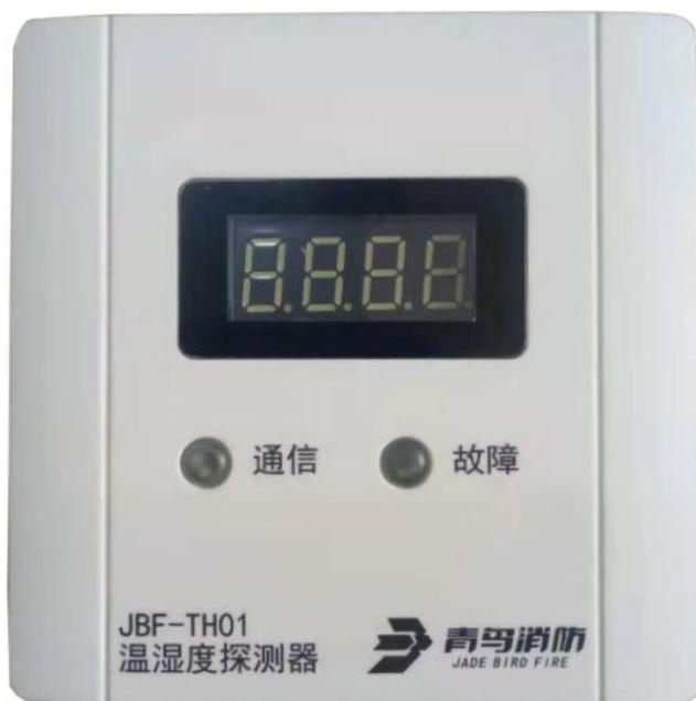
JBF-TH01 温湿度探测器采用全新设计的 ASIC 专用芯片，外观小巧，灵敏度高，响应迅速，抗干扰能力强，通过温湿度传感器实时将温度、湿度数据，经无极性二总线传送到环境质量控制器，以便让控制器根据预设的联动逻辑，启动或停动风机设备，来改善地下车库等安装场所的环境质量。JBF-TH01 温湿度探测器可以通过青鸟消防电子编码器对其进行地址
